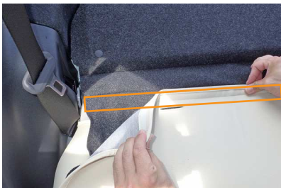
15 シート背面下の生地裏に付いているマジックテープをシートに直接貼り付けて固定します。
