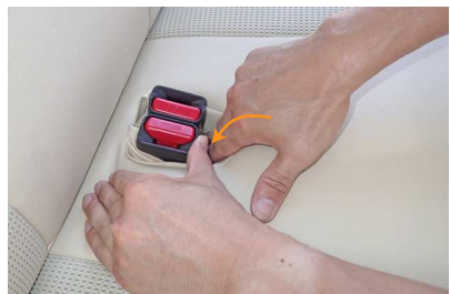
18 バックル収納部分に生地を入れ込みます。
