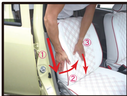
⑧①→②→③の手順で背もたれ側面の生地を、シートに馴染ませていきます。側面のシワが消えるまで繰り返して行って下さい。
