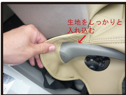
⑪カバーをかぶせます。 始めにリクライニングレバーをカバーの加工穴に通します。レバーの根本にしっかりと生地を入れ込みます。
