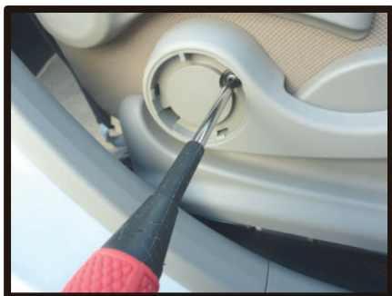
⑨ネジをドライバーで外します。
