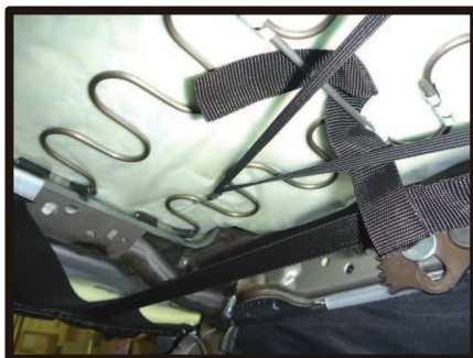
⑪S字フックはシート裏の金属部分に引っかけて固定します。
