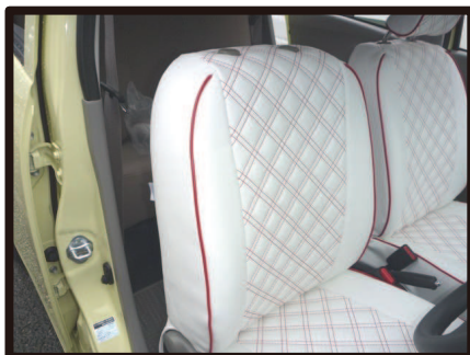
⑫サイドエアバッグ装備車は、サイドエアバッグの展開部分とシートカバーのSAB対応の縫い目部分が合っていることを確認して下さい。カバーのラインを整えて、1列目運転席側背もたれの完成です。助手席側も同様に取り付けます。
