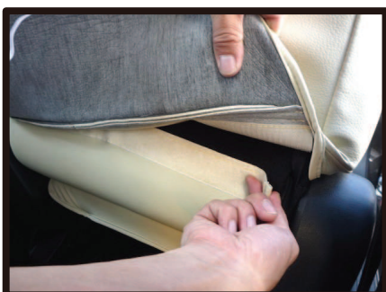
⑨⑦で引き出した生地と、カバーの背面をマジックテープで固定します。
