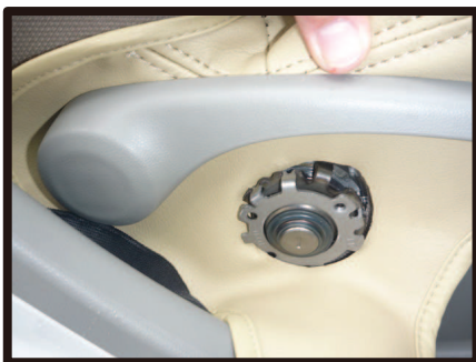
⑫生地の利用を利用して、ゆっくりとレバーを抜き出します。作業は慎重に行ってください。カバーの加工穴からシートリフターの軸を出します。
