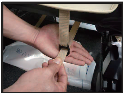
⑬ 1ページ⑫のベルトをシート背面から取り出し、⑩で引き出した生地についているバックルと固定します。
