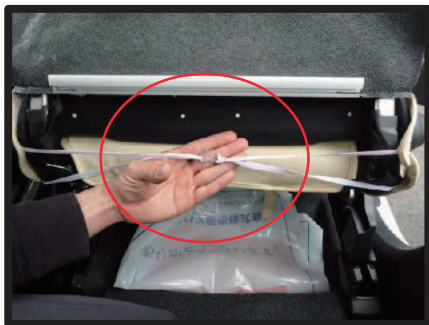
⑰ カバー側面に付いているゴムを付属のS字フックを使用して、図のように固定します。
