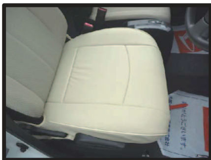
⑩ シートのラインを整えて1列目運転席座面の完成です。助手席側は一部形状が違いますが同様に取り付けを行います。
