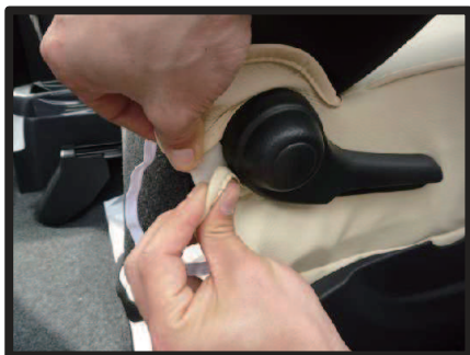
⑯ リクライニングレバー後方の生地をマジックテープで固定します。
