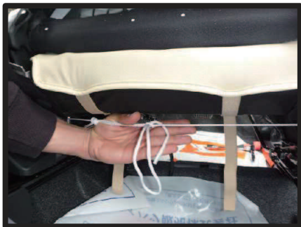
⑮ カバー側面から出ているヒモは、片方のヒモで輪を作り、もう片方のヒモをその輪に通して引き絞り結び留めます。ヒモは強く引きすぎると切れる、または生地が裂ける等の恐れがありますので、ご注意ください。
