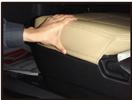
⑥ シート本体とプラスチックカバーの間に生地を入れ込みます。
