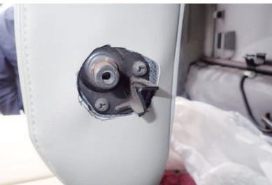
8 アームレスト装備車は、背面内側のファスナーを閉じる際に、図のようにアームレストの軸部分をかわす穴開け加工をします。カバーに目印を付け、ハサミ等を使用し、大きく穴を開け過ぎないよう慎重に作業して下さい。
