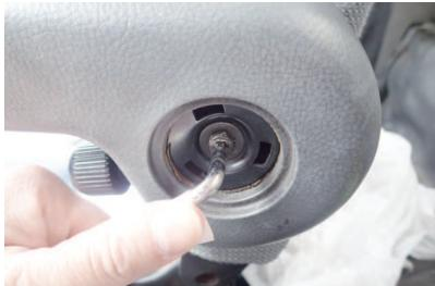
1 始めに、運転席アームレスト装備車は、トルクスレンチ（T30）を使用し、アームレストを取り外します。
