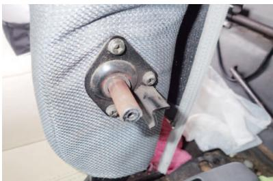
2 アームレストを取り外すと、シート側に軸がありますので、カバー装着時にこの軸部分をかわすよう、穴開け加工が必要となります。（8番参照）
